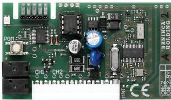
**Steck-Empfänger** für mit Schnell Molex-Stecker ausgestattete Steuergeräte.
