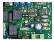
**Récepteur intégré** dans la centrale de commande avec programmation à l'aide de boutons et de trimmer/dip-switches.
