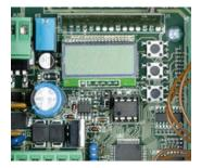
**Récepteur intégré**, dans la centrale de commande avec programmation à l'aide d'unécran LCD. Sur ce type de centrales, il y a toujours un menu radio par l'intermédiaire duquel il est possible d'effectuer toutes les opérations de programmation du récepteur intégré. Le menu radio permet également la gestion des fonctions avancées spécifiques à chaque appareil.
