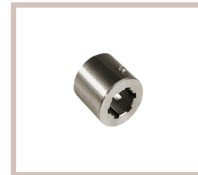
AU.45B Casquillo estriado Ø 21,2 mm con orificio de fijación M6.
