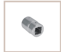
ZED.20Q Casquillo estriado Ø 21,2 mm de perfil cuadrado 20x20 mm. Con orificios de fijación M6. L = 62 mm
